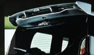
翼端板付きのリアウイングは、純正ルーフスポイラーの上に被せる構造。ステーで支えるレー<sup>シ</sup>な形状で、ロゴプレートが中央に備わる。
