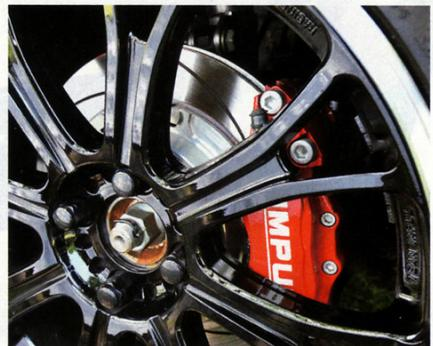
▲フロントに備えられた6ポットキャリパーには、ステンレスホールもセットで装着される。これにより剛性感の高いペダルタッチを実現している
