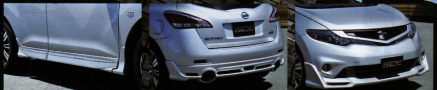
片側3ピース構造となるサイドステップ。流れるようなラインワークが、純正ボディとマッチする。モールは純正を流用している。
