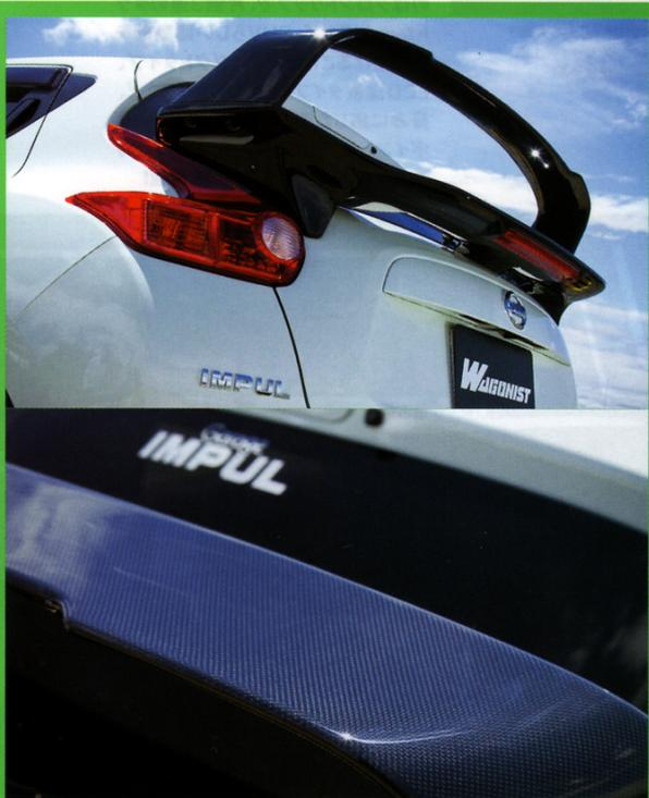
足付きのウイングに、さらに足付きのGT風ウイングを重ねたような個性&スピード感全開のリヤダブルウイング。トップウイングはFRP&カーボンを設定。自立角度は激高!
