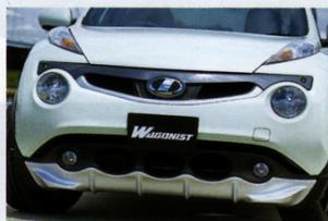
↑フロントグリルは純正と交換装着するタイプ。インパルのフロントエンブレムが付属されるほか、両サイド・丸形ヘッドライト上部分には、LEDデイトライトを内蔵できる
