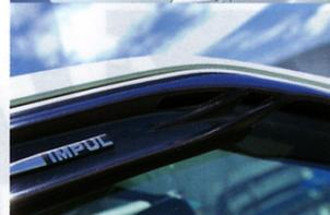
↑ウインドウ部分に装着するエアロサイドバイザーもラインアップ。バイザー本体が穴の開いた構造になり、コからしっかり空気が抜け、室内の換気に役立つのだ!
